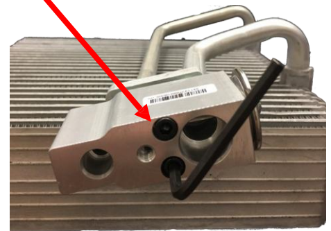
4. Conecte la válvula de expansión al accesorio usando un hexagonal de 4 mm para instalar los tornillos.
