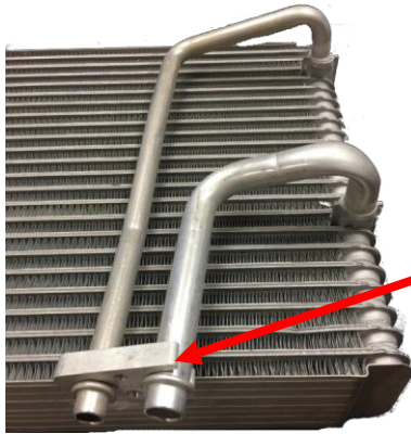
1. Coloque el clip en las líneas del evaporador (como se muestra arriba).
