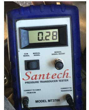
5. En modo manual puedes contralar el voltaje pasando al transductor para ver si esta trabajando entro la variedad de voltaje propuesto por el fabricante.
