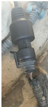
3. Conecte la herramienta transductor de presión entre el presostato del transductor y el conector eléctrico.
