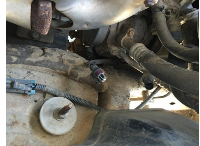
2. Desconecte el presostato del transductor.
