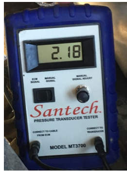
4. La herramienta transductor de presión se prende cuando se arranca el vehículo. Esta imagen ensena el señal de voltaje.
