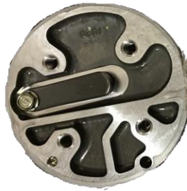
Lado Posterior de Descarga del scroll del compresor
