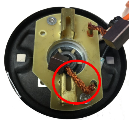
Figura: 1.1: Fíjese en las escobillas de carbón que pueden desgastarse con el tiempo.
