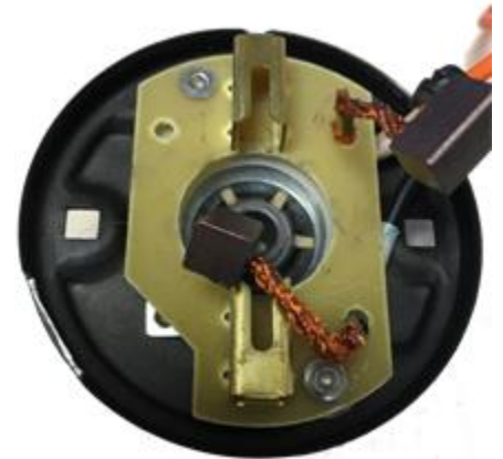
Figura: 1.1: Observe las escobillas de carbón que pueden desgastarse con el tiempo.
