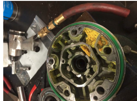
En la imagen de arriba: sellador solidificado atrapado en el cilindro y el cabezal
