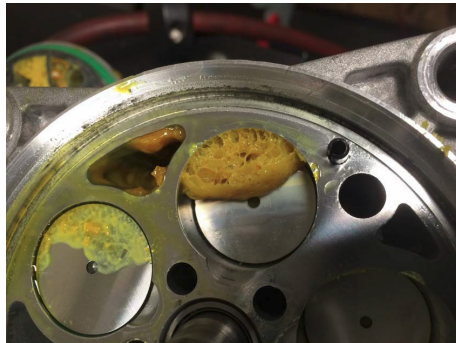
En la imagen de arriba: sellador solidificado atrapado en el cilindro y el cabezal
