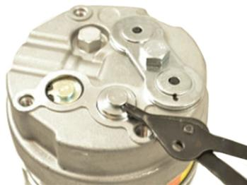
5. Retire y deseche la pieza en bruto del interruptor del compresor.
