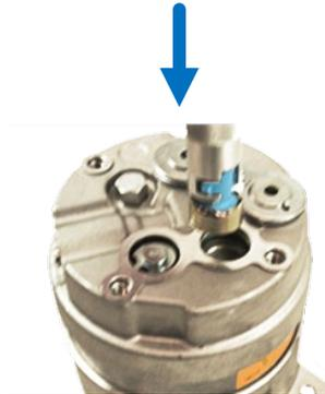
4. Inserte el anillo de retención y presione alrededor de los bordes. Asegúrese de que el anillo de retención se asienta correctamente en el puerto del interruptor. **(Tenga cuidado al instalar el anillo de retención)**
