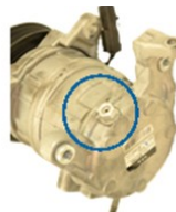
Ausencia de la tapa de la válvula de alivio, por lo general, causada por la alta presión
