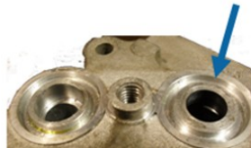
La contaminación en la línea de succión muestra que el sistema tiene residuos
