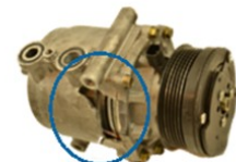
Daños en la caja causados por la alta presión por no cambiar el condensador
