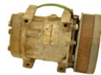
Oxidación externa, por lo general, causada por una exposición excesiva al medio ambiente
