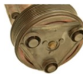
Embrague quemado por problemas de alta presión o voltaje
