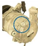
L'absence de couvercle de soupape éclaté est généralement causée par une pression élevée.
