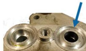
La contamination de la conduite d'aspiration montre que le système contient des débris.
