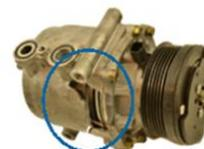
Domages au boîtier causés par la haute pression due au fait que le condenseur n'a pas été remplacé
