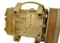
Rouille/oxydation externe généralement causée par une exposition excessive à l'environnement
