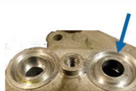
La contaminación en la línea de aspiración muestra que el sistema contiene residuos.
