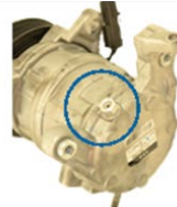
Falta de la tapa de la válvula generalmente causada por la alta presión
