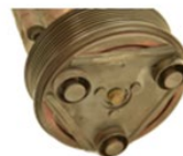
Embrague quemado por un problema de alta presión o tensión
