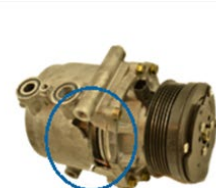
Daños en la caja causados por la alta presión al no cambiar el condensador
