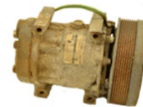
Herrumbre/oxidación externa causada generalmente por una
