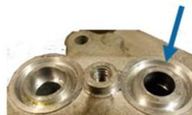
La contaminación en la línea de aspiración muestra que el sistema contiene residuos.
