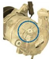
La tapa de la válvula que falta por lo general causada por la alta presión
