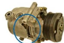
Caja dañada por alta presión al no cambiar el condensador
