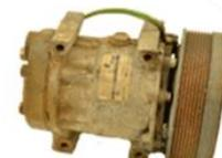
Herrumbre/oxidación externa causada normalmente por una exposición excesiva al
