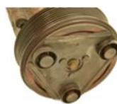
Embrayage brûlé par un problème de haute pression ou de tension
