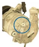
Défaillance du couvercle de soupape habituellement causée par une
