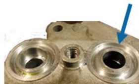
La contamination de la conduite d'aspiration montre que le système contient des déchets.
