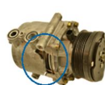
Dommages à la boîte causés par une pression élevée en ne changeant pas le condenseur
