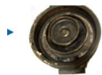
Embrayage brûlé par un problème de haute pression ou de tension
