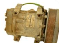
Rouille/oxydation externe habituellement causée par une exposition excessive à
