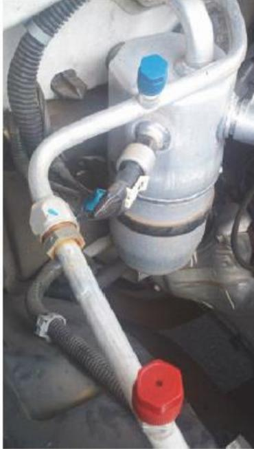
Los puertos de servicio del lado bajo y alto en algunas aplicaciones de GM, con el tubo de orificio en el centro.
